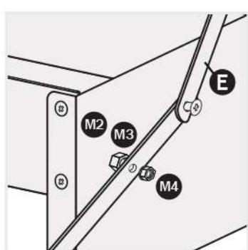
Napomena: Molimo ostavite malo prostora između dijela B i željezne šipke E te vijka M3 i vijka M4 (M4 ima zaustavljač na jednoj strani kako bi se spriječilo ispadanje vijka, a M4 je deblji i treba biti postavljen izvana)
